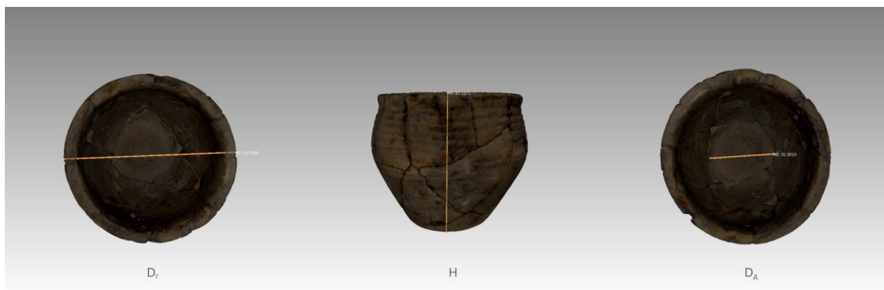
Рис. 2. Извлечение линейных параметров керамического сосуда в программной среде MeshLab Fig. 2. Extraction of linear parameters of a ceramic vessel in MeshLab
