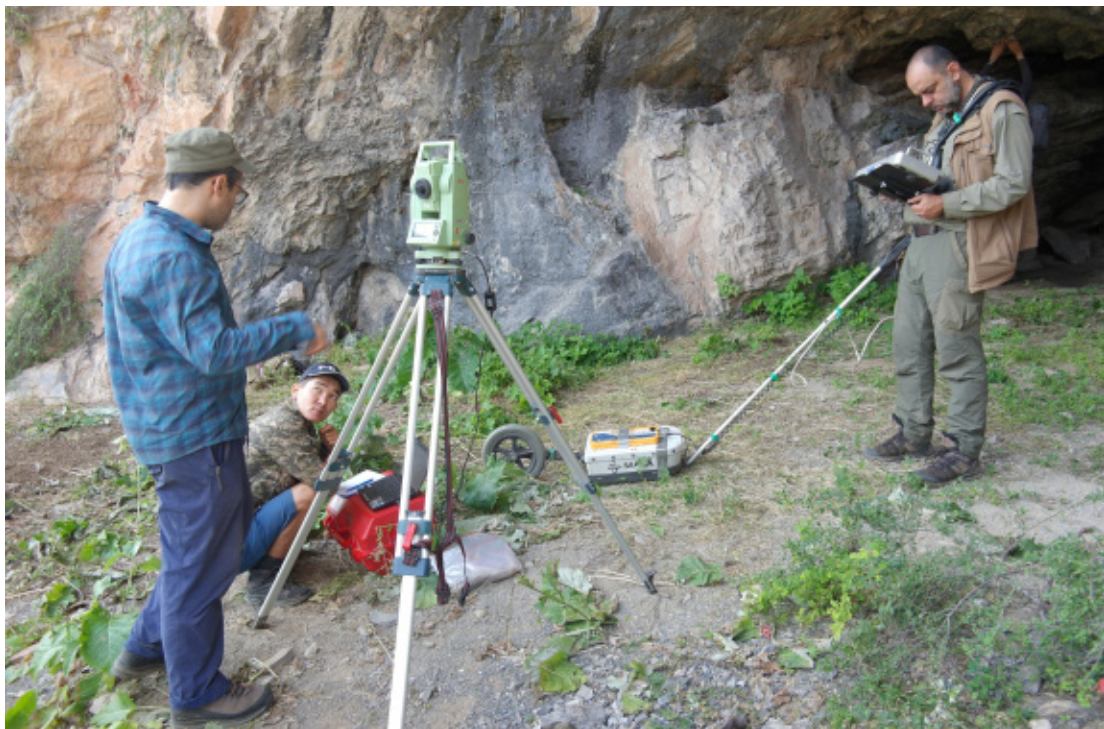
Рис. 6. Зондирование отложений с помощью георадара (пещера Марсель, Туркестанская область, 2019)
