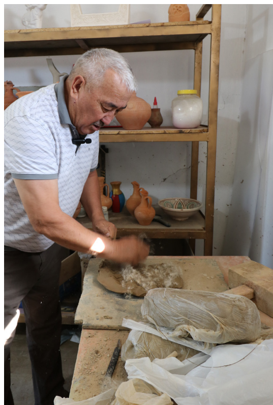
Рис.1. Подготовка формовочной массы «глина + камышовый пух». Мастер - Абайхан Рыспаев.
